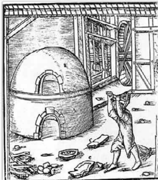
10. Una fornace per la fusione del vetro in una raffigurazione del sedicesimo secolo. (Agricola 1556).
